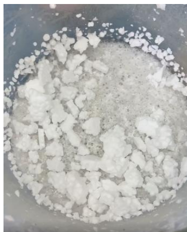
Figura 14: Reciclagem de EPS em solução de acetato de etila.
