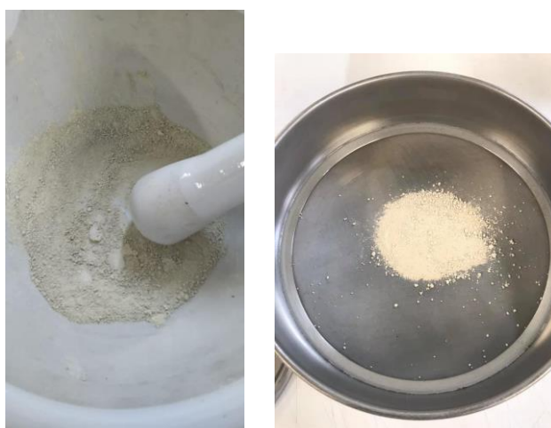
Figura 13: Amostra de argila branca sendo moída durante o processo de modificação.
