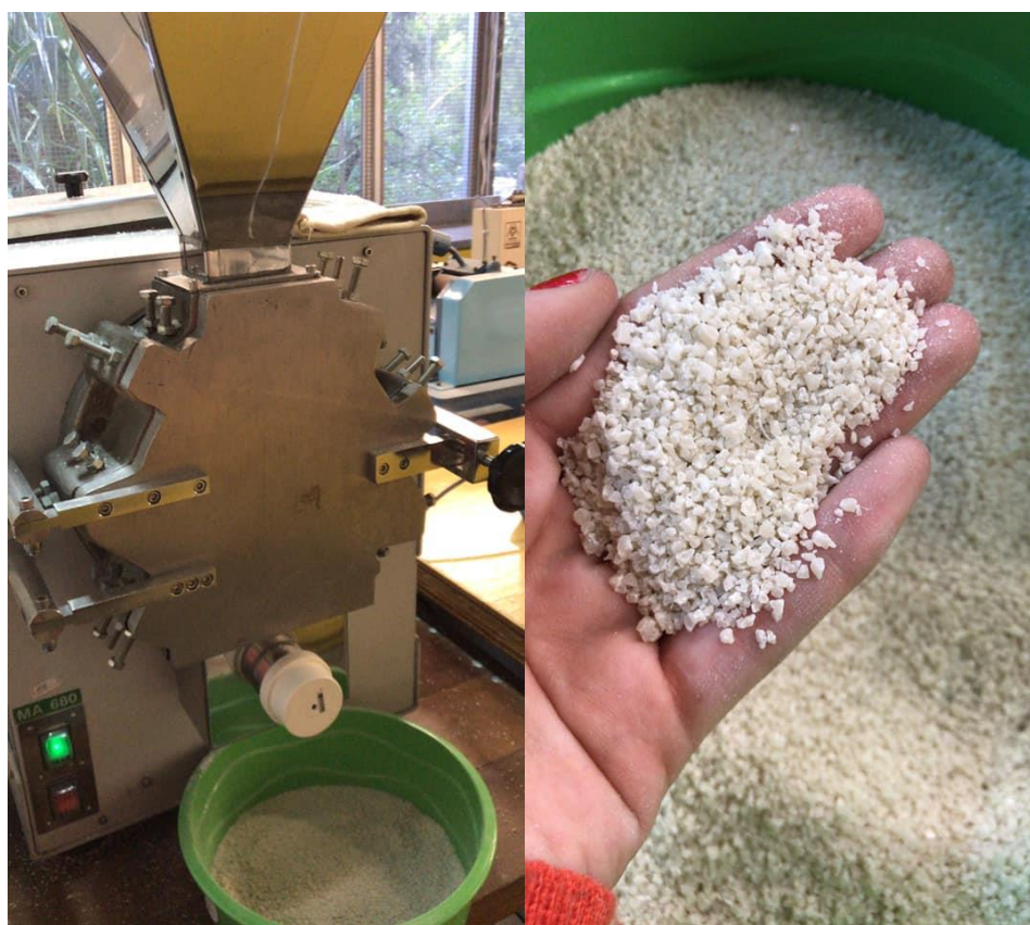
Figura 17: Amostras durante moagem em moinho de facas.
