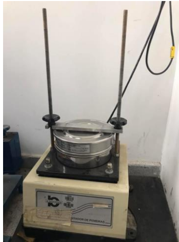
Figura 11: Amostra de argila branca no agitador mecânica durante o processo de modificação.
